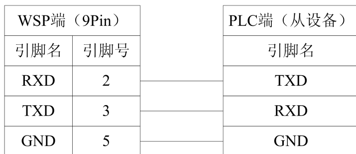
图 5.8 WSP 与 MODBUS 协议的 RS232 连接图
