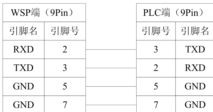
图 5.6 WSP-LG-CAB 连线
