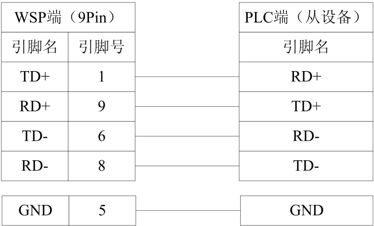
图 5.9 WSP 与 MODBUS 协议的 RS422 连接图
